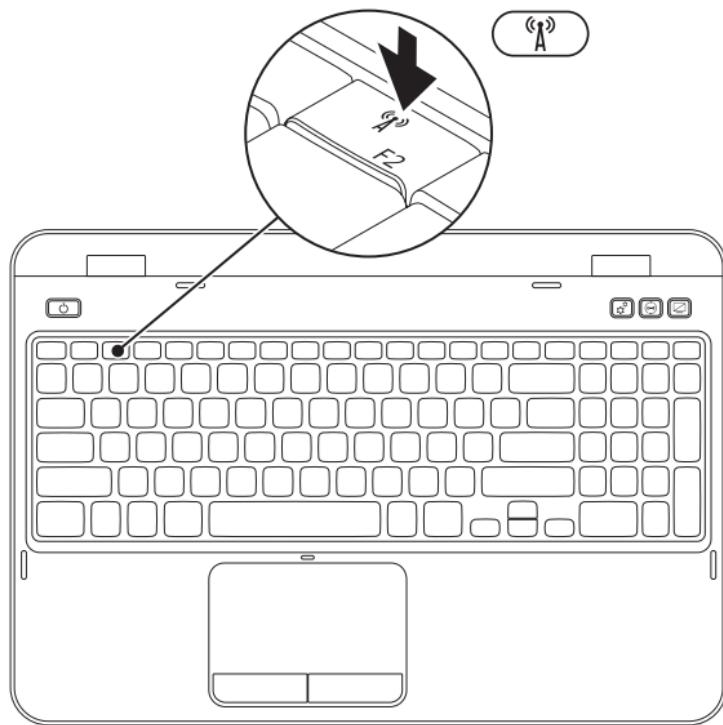
Для включения или Выключения беспроводного режима:
